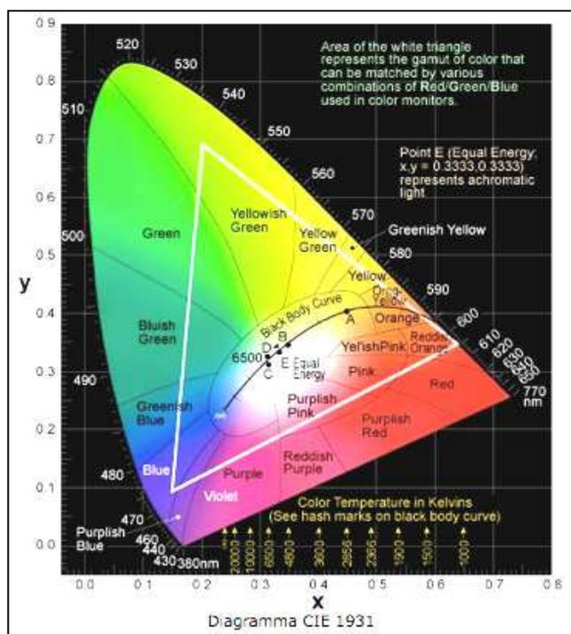
sorgenti luminose a LED hanno una temperatura molto variabile a seconda del modello scelto. Inoltre, è utile ricordare che la luce solare diretta a mezzogiorno possiede una  $T_{CP} \approx 5000 K$ , che è
