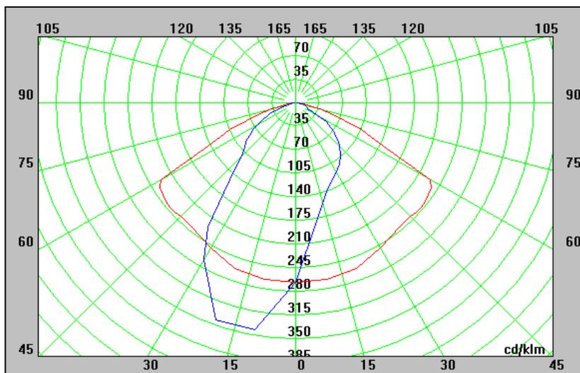
Le curve fotometriche sono espresse in  $cd/klm$ , relative ad una lampada dello stesso tipo di quella montata nell'apparecchio illuminante, avente flusso luminoso di 1000 lm. Per gli apparecchi da interno e per le armature stradali, le curve fotometriche sono rappresentate in coordinate polari  $C/\gamma$ , per i proiettori in coordinate cartesiane  $V/H$ .
